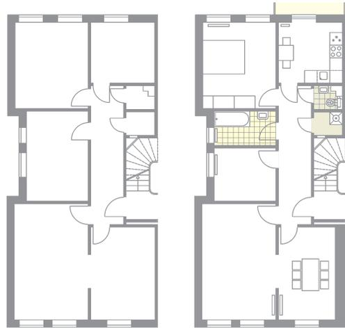
**Abb. D.14.5:** Aus dem alten Minibad wäre auch mit dem anliegenden Nebenraum kein geräumiges Bad geworden. Deshalb wurde ein Raum, der sich dafür anbot (2 Fenster), geteilt. Die Leitungen mussten durch die Holzbalkendecke zu den Steigsträngen im alten Bad verzogen werden (Abb. D.14.8 und D.14.9).
