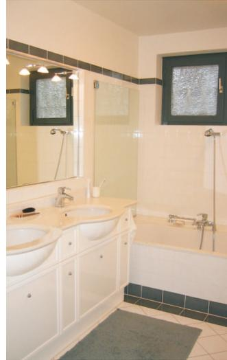
**Abb. D.14.1:** Zustand des Bads der Abb. D.14.2 bis D.14.4 vor dem Umbau. Die Fenster sind typisch für frühere Bäder: klein, hoch gesetzt und mit undurchsichtigem Glas versehen. Der Raum musste abgeschlossen und vor Einblick geschützt sein.
